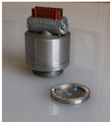
Рис. 4. Сенсор тиску і його мембрана з термочутливими елементами
