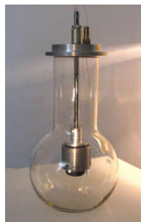
Рис. 5. Вакуумована колба з сенсором
