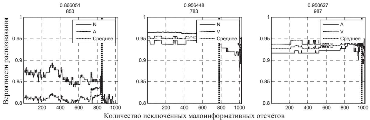
Рис. 6. Вероятности распознавания комплексов в зависимости от числа исключённых малоинформативных отсчетов при использовании матричных портретов сигналов
