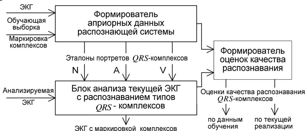
Рис. 2. Структура анализатора сигналов
