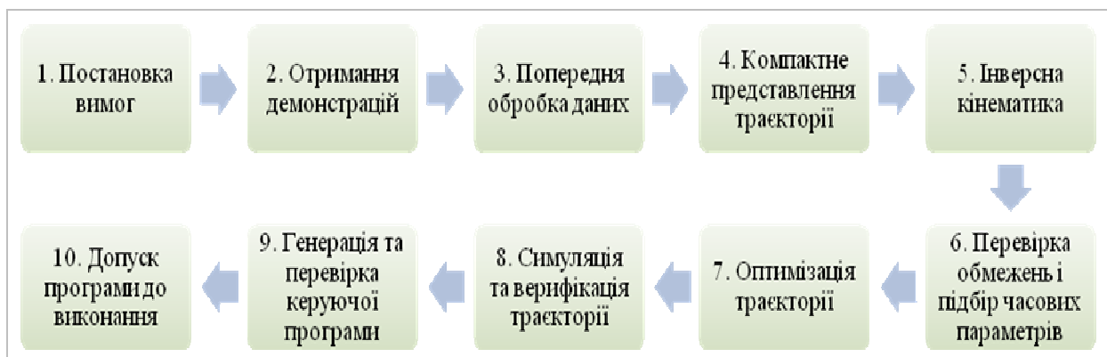
Рис. 1. Узагальнена послідовність етапів формування програми руху в системі навчання за демонстрацією для промислового робота-маніпулятора
