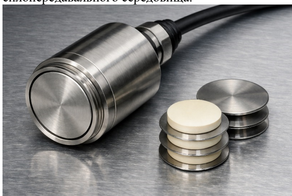
Рис. 1. Прототип авторського п'єзоелектричного керамічного датчика
