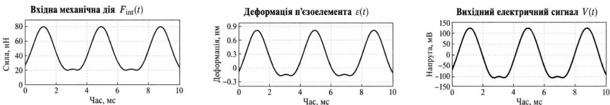
Рис. 3. Схема прямого перетворення механічної взаємодії у вихідний електричний сигнал при роботі вимірювального інструмента АСМ
