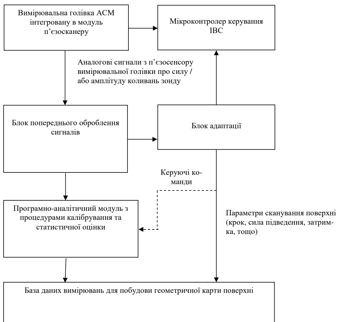
Рис. 1. Структурно-функціональна схема розробленої авторами інформаційно-вимірювальної системи
