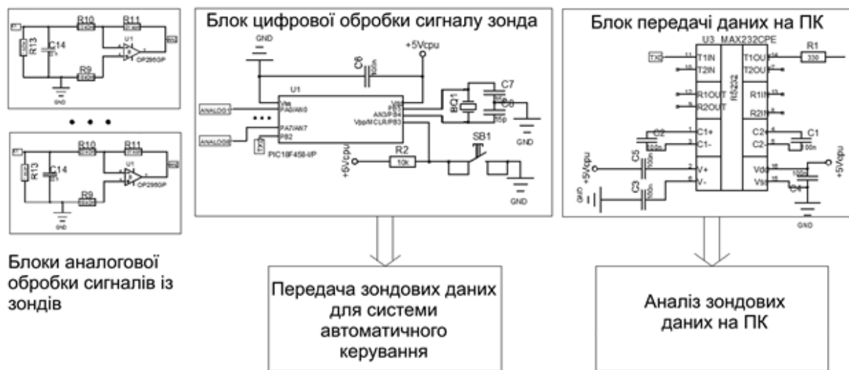
Рис. 2. Структурна електрична схема мікропроцесорного модуля моніторингу
