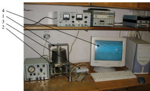
Рис. 2. Система для експериментального встановлення статичних характеристик та параметрів точності сенсора
