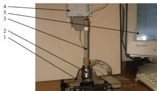
Рис. 6. Установка силової імітації імпульсу тиску
