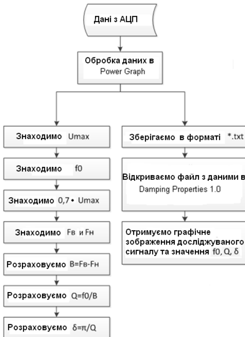
Рис. 3. Алгоритм розрахунку демпфуючих характеристик
