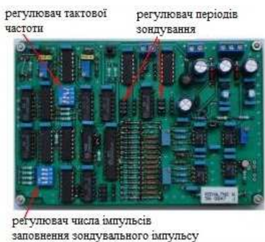
Рис. 8. Зовнішній вигляд монтажної плати формувача
