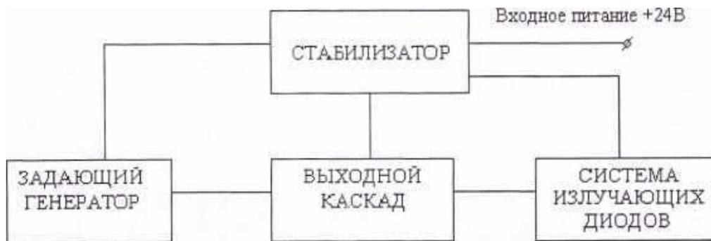
Рис. 3. Структурная схема излучателя
