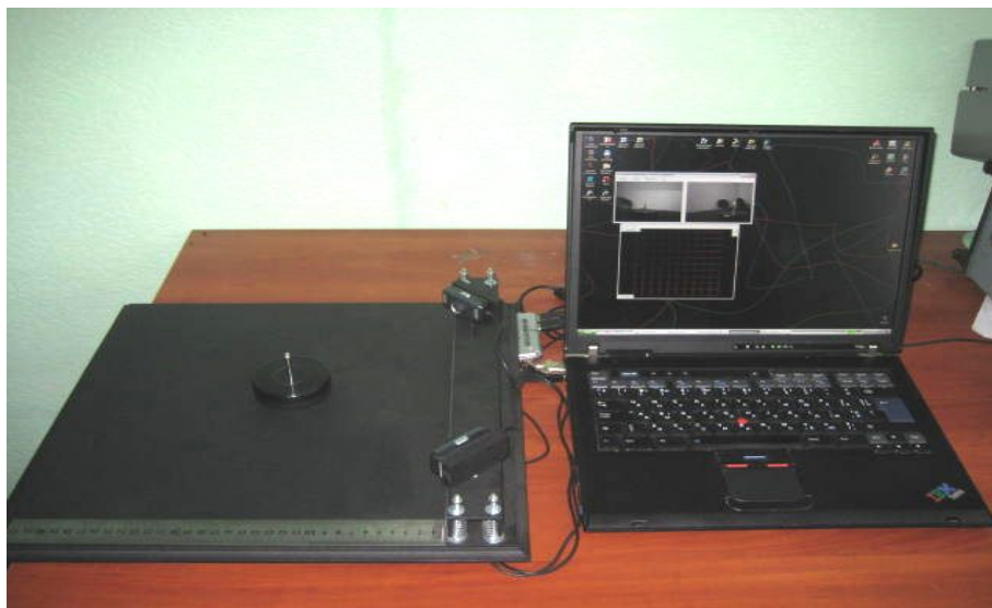
Рис. 3. Общий вид исследовательского стенда для определения пространственных координат преобразователя дефектоскопа
