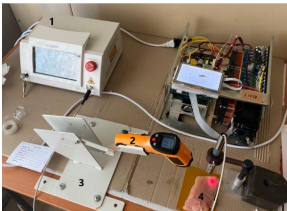
Рис. 1. Експериментальна установка 1 – лазер хірургічний діодний Lika-surgeon, 2 – пірметр, 3 – затискач, 4 – біологічний зразок
