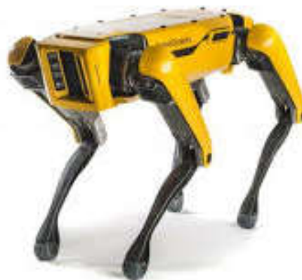
Рис. 2. Крокуючі платформи із чотирма кінцівками від Boston Dynamics [2]
