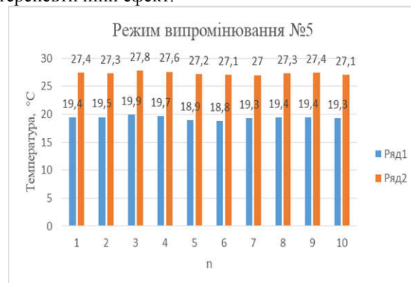
Рис. 6. Діаграма зміни температури експериментального зразка до і після опромінення режимом №5
