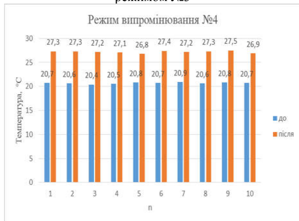
Рис. 5. Діаграма зміни температури експериментального зразка до і після опромінення режимом №4
