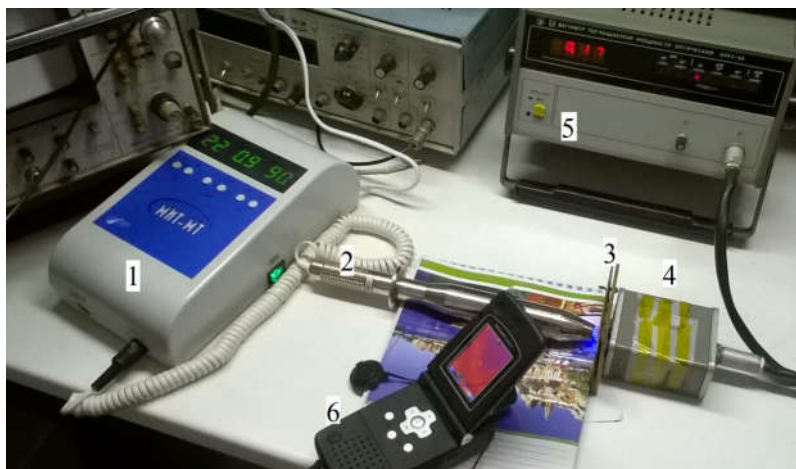
Рис. 2. Апаратурна установка, де: 1) МІТ-МТ, 2) випромінювач для гінекології, 3) біологічний зразок, 4) приймач оптичного ватметра, 5) оптичний ватметр ОМЗ – 65, 6) ІЧК «MobiR M3»
