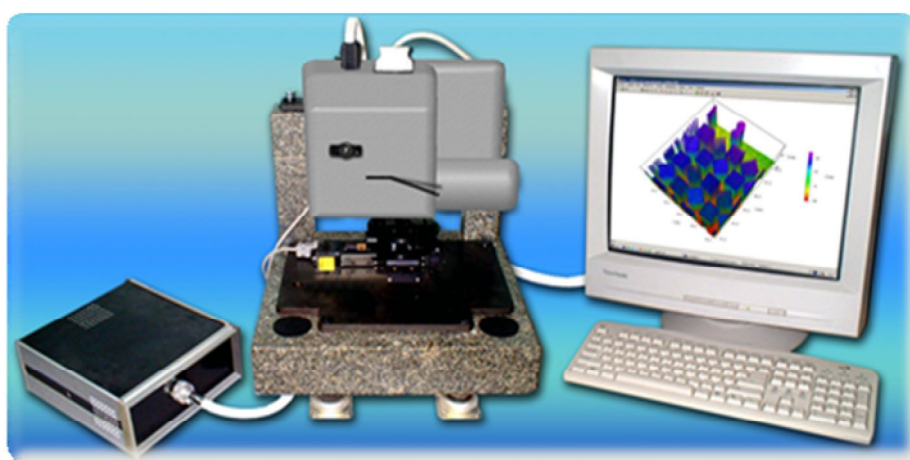
Рис. 2. Інтерферометр білого світла «Рельєф»
