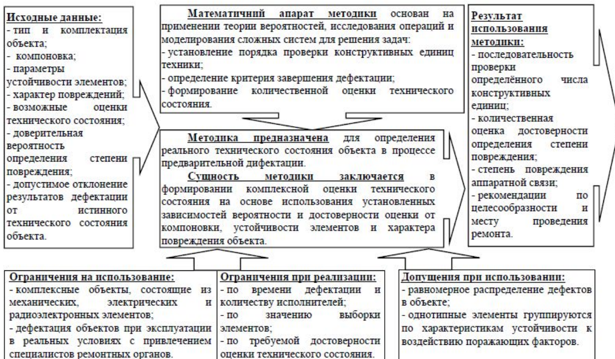
Рис. 1. Структурная схема методики предварительной дефектации аппаратных связей с множественными повреждениями в полевых условиях
